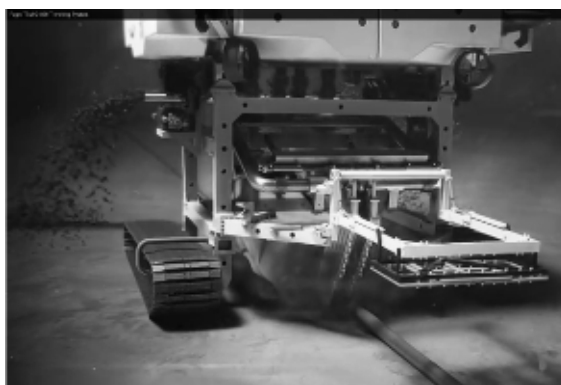
Figure 27 – ROV à jets hydrauliques
