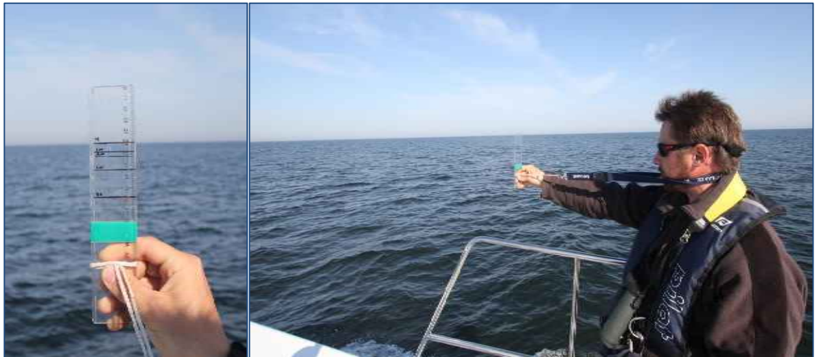
Figure : utilisation de la règle de mesure pour estimer les distances en mer.
