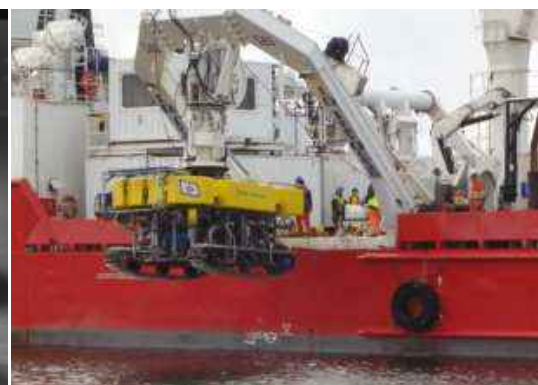
Figure 27 – ROV à jets hydrauliques
