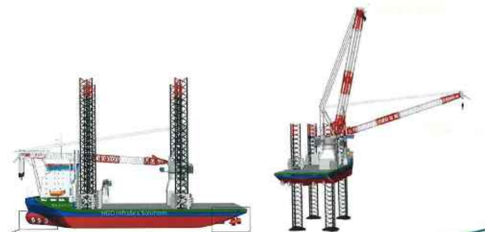
Figure 20 – Navires HGO Innovation en mode navigation et en mode élevé (source HGO)
