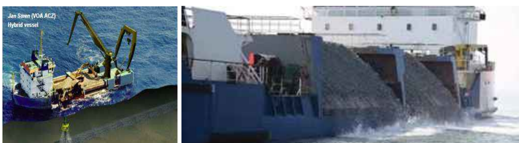
Figure 32 – Exemple de navire durant une opération de dépôt de matériaux (source DONG Energy)
