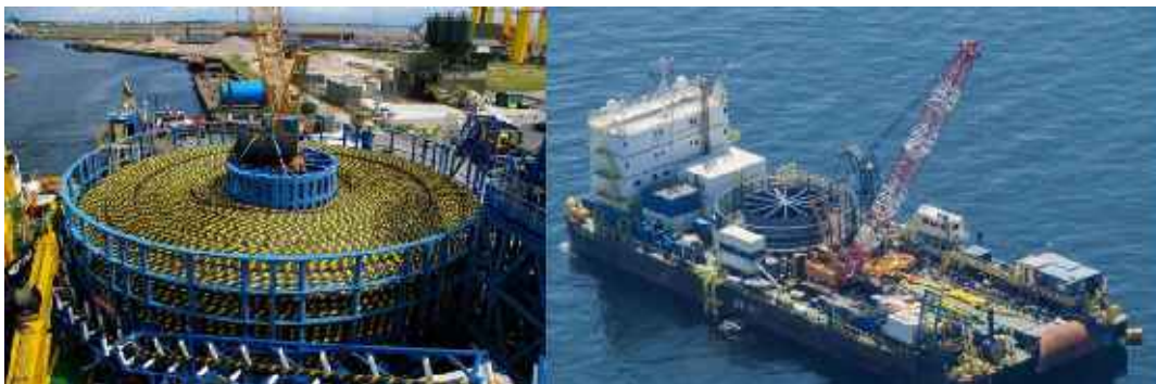
Figure 23 – Barge équipée d'un carrousel (source DONG Energy)
