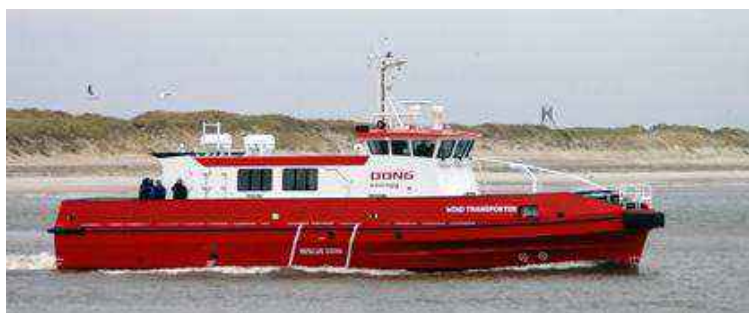
Figure 37 – Navire de transfert monocoque sur le parc éolien en mer d'Horns Rev (source DONG Energy)
