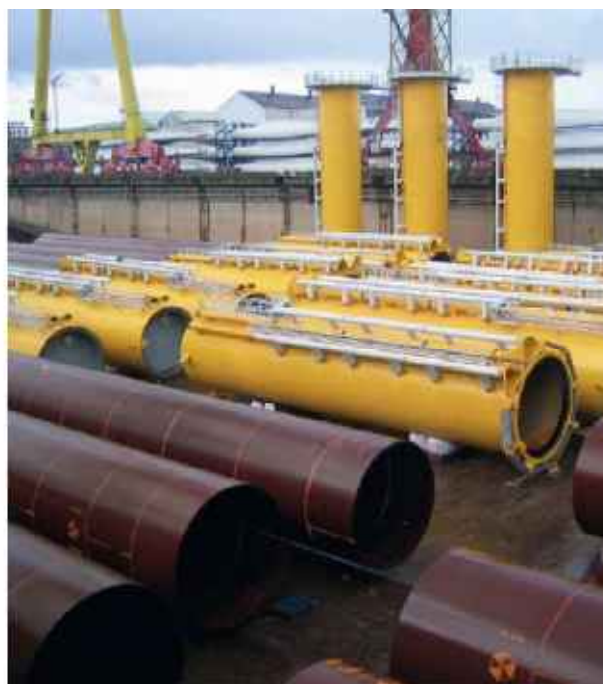
Figure 3 - Fondation de type monopieu retenu pour le projet et pièces de transition (Source : DONG)
