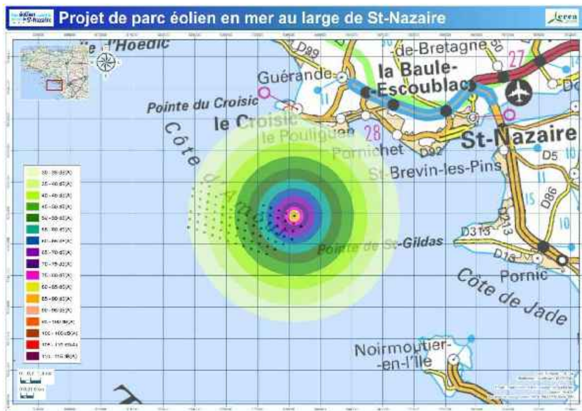
Figure 49 - Courbes isophones des niveaux sonores du battage du monopieu de l'éolienne G07 (EREA Ingénierie, 2013)
