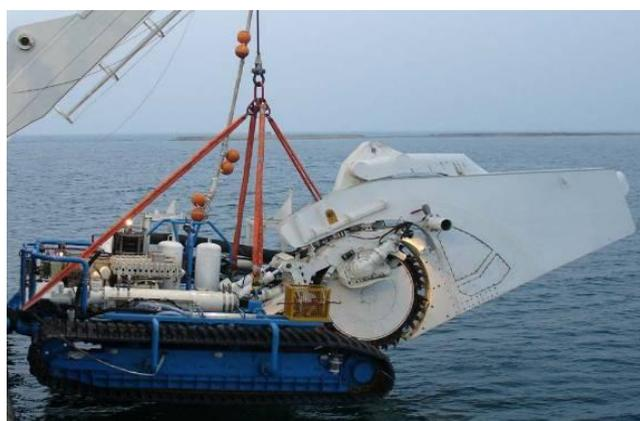
Figure 20 : Machines d'ensouillage – en haut à gauche un ROV de jetting, en haut à droite une charrue et en bas une trancheuse (sources LD Travocean & Oceanteam)
