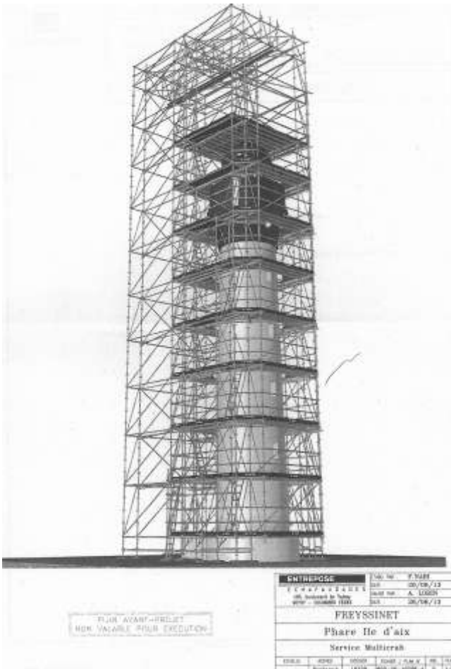
Plan 3D de montage de l'échafaudage
