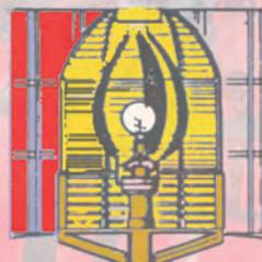
Électrification au moyen de deux puis trois groupes électrogènes. Le feu fixe, transformé en feu à occultations avec trois secteurs colorés, est situé à 60.30 m au dessus du niveau des marées de vive-eau moyenne.
