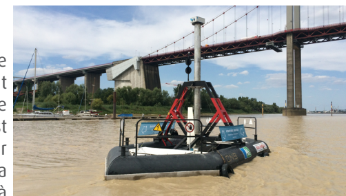
Hydrolienne H3 d'Hydrotube Énergie Tests réalisés sur la Garonne - Pont d'Aquitaine (Source : Hydrotube Énergie)
